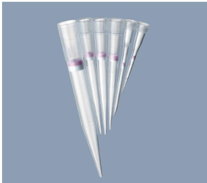
ep Dualfilter T.I.P.S.<sup>®</sup> SealMax 双层超滤芯具有全新紫色和白色滤芯层，近 100% 阻隔气溶胶，有效防止移液器被样品溶液污染。气溶胶：气溶胶粒子和周围的空气粒子，或在气体介质中弥散的固体或液体微粒，一般为空气和生物大分子。当接触到过量移取的样品时，新的双层滤芯会立即闭合，不会对珍贵样品造成影响。此外，白色滤芯层截留液滴和飞溅，紫色滤芯层高效阻隔样品溶液。
